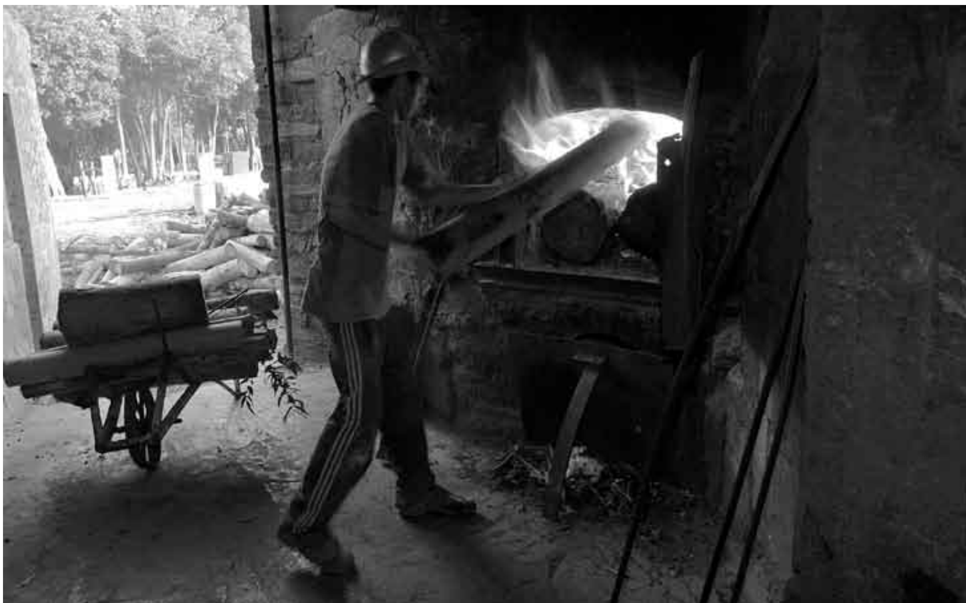
Trabajador foguista durante la carga con troncos de eucaliptus blanco de uno de los hornos de una calera. * FOTO: FERNANDO MORÁN
